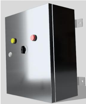
Fabricado em aço inoxidável com configuração apropriada para ambientes agressivos e ao tempo, possui 3 entradas para cabos através de prensa cabos localizados em sua face inferior, com tecnologia Schneider para monitoramento de isolamento, possui 2 estágios de alarme: 1 com 50k $\Omega$  alarme visual amarelo e outro com 100k $\Omega$  alarme visual vermelho.
